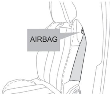
Система предназначена для защиты водителя и пассажира переднего сиденья в случае тяжелого бокового удара от травм грудной клетки, области между тазобедренным суставом и плечом.
