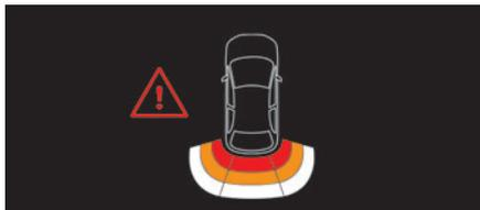
Система дополняет собой звуковой сигнал, отображая на экране полосы, которые указывают на расстояние между препятствием и автомобилем (белые: удаленные препятствия; оранжевые: близкие препятствия; красные: очень близкие препятствия).
